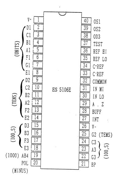
**ア**承求資訊科技 ESJ100 CYRUSTEK CO. 3 1/2 DIGIT A/D CONVERTER W/LCD
